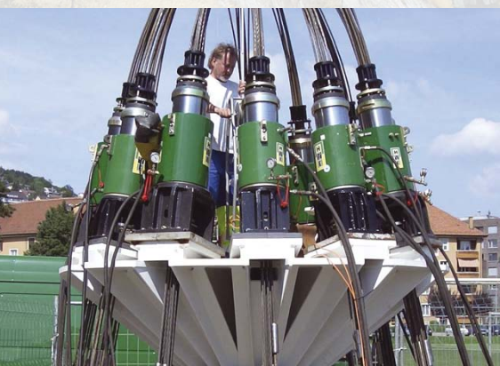
Pfahlbelastungsversuche: Zürich, Hardturmstadion
