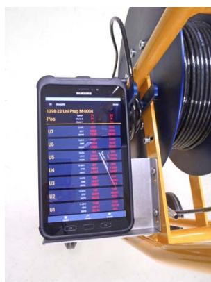
Kabelrolle auf Rollwagen mit PCD und Android-Gerät auf Ablage
