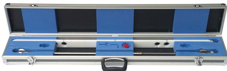
Gleitdeformetersonde mit Führungsschwert im Tragkoffer
