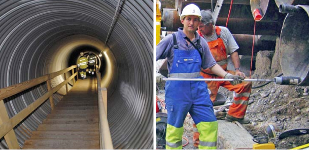
Autobahn A16 Transjurane, Neubau Streckenabschnitt Roches-Moutier, Kanton Bern: Trivec-Messungen in einer Pfahlwand
