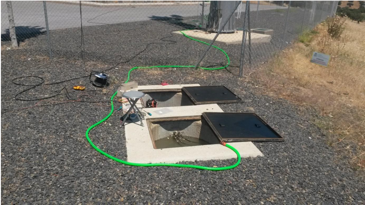
Leckage-Simulations-Test am Villalba de los Barros Damm, Spanien
