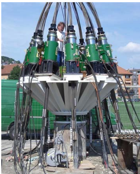
Bild 7: Versuchsaufbau und Gleitmikrometermessung
