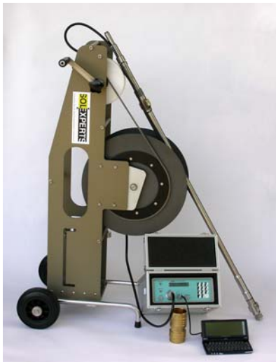
Bild 8: Messausrüstung für Gleitmikrometer
