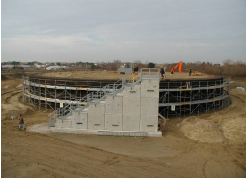
Abb. 4: Venezia, Bocca di Lido: Konsolidationsversuch; mit Gleitdeformeter instrumentiert
